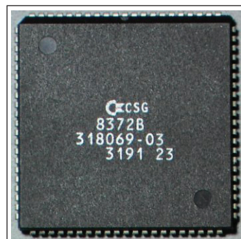
Fig.4: Para que se tenha uma idéia, esse é o “Agnus”, e a foto retrata o produto final daquele monstro de 7 placas que era na fase de protótipo! Foi desenvolvido inteiramente por Jay Miner.
