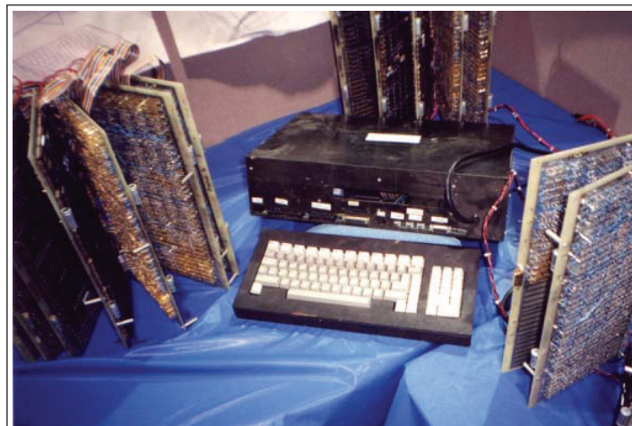
Fig.3: Aqui o conjunto completo com os 3 chips customizados (protótipos) e a unidade base que era o protótipo final do que antes foi chamado de "peace" e "war", com várias portas de I/O, e um teclado.
